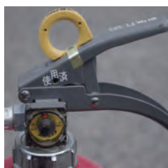
× 表示装置の脱落
