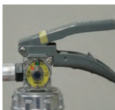
× 安全栓の脱落
