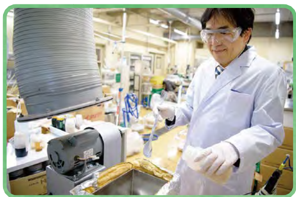
森林総研内の実験室にある改質リグニン製造プラントの初期小型版。なんとパンこね機を流用して作ったのだとか!
