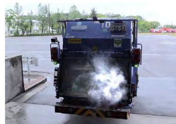
ゴミ収集車車内の発火事故の再現
